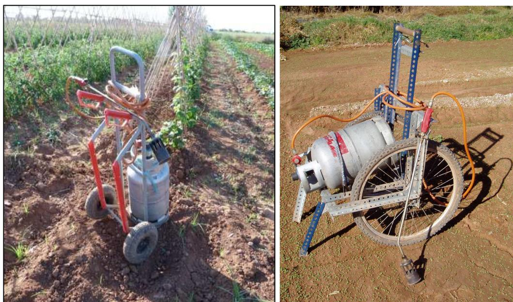
**Figura 6. Diseños de carritos con quemadores con diferentes diámetros de rueda y distancia de ejes.**
