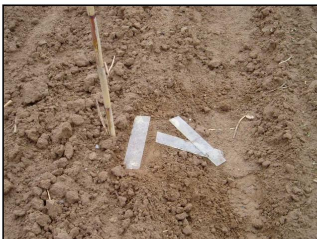
**Figura 10. Disposición y señal de posicionamiento del vidrio indicador.**
