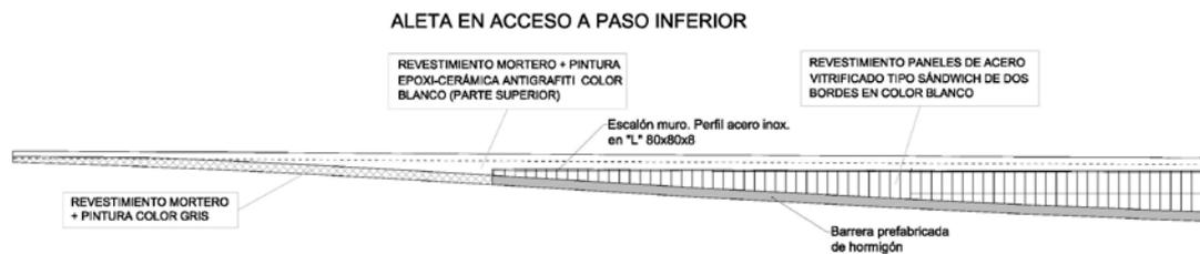
Imagen 27. Alzado de revestimiento en aletas de acceso
