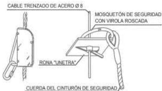
ANCLAJES CINTURÓN DE SEGURIDAD
