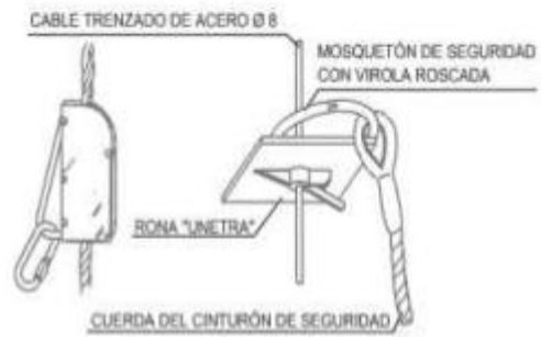
ANCLAJES CINTURÓN DE SEGURIDAD
