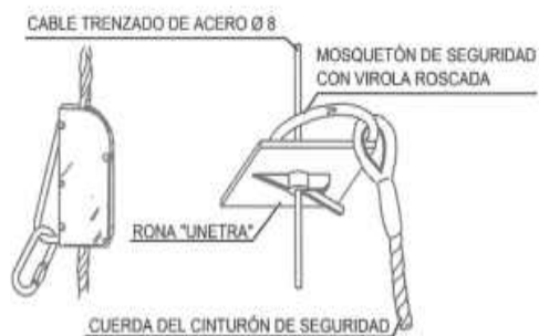
ANCLAJES CINTURÓN DE SEGURIDAD
