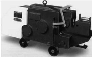
Máquina para el corte intermitente o continuo de barras de acero. Consiste en un motor eléctrico, un desmultiplicador, un embrague accionado por un pedal o una palanca manual, y un soporte para las barras.
