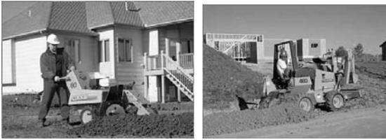
Máquina para excavar zanjas. Un motor mueve una cadena con puntas de cuchara que arrancan y elevan la tierra hasta un tornillo sin fin que la retira, amontonándola a un lado. Hay modelos que se operan a pie y otros autopulsados.
