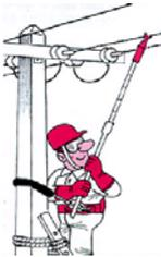
La versión para instalaciones de alta tensión sustituye los bornes por una pértiga con mango aislado, con una pinza en un extremo para establecer contacto con la línea (generalmente elevada) y un conductor flexible y otra pinza en el otro extremo para establecer la conexión a tierra (ilustración de la web de la Asociación para la prevención de accidentes APA)
