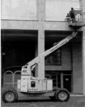
*Plataforma elevadora autopropulsada tipo telescópica*
