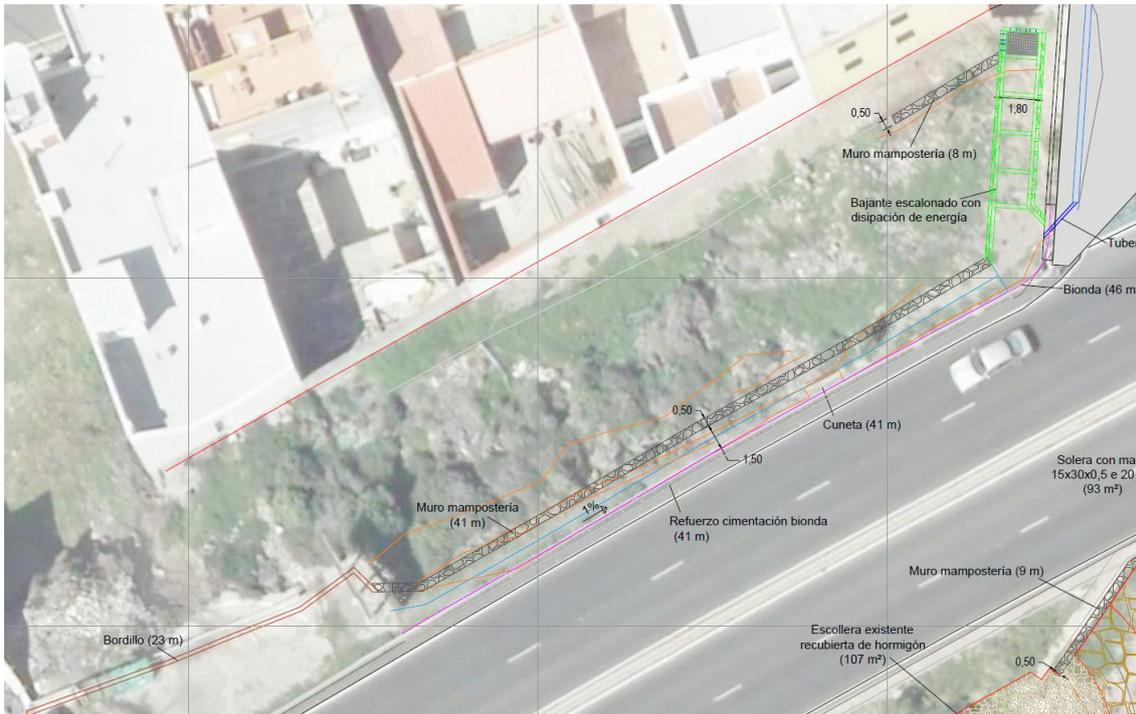
Planta del drenaje del terraplen por el lado del derrumbe
