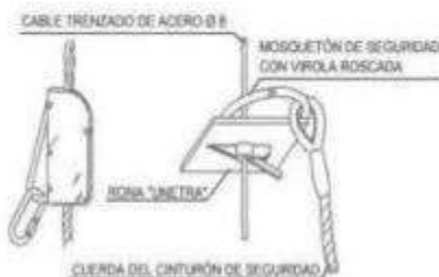
ANCLAJES CINTURÓN DE SEGURIDAD
