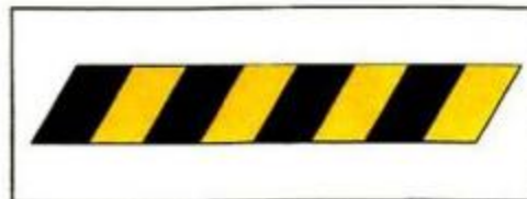
Figura 9.6. Señal de riesgo de caídas, desniveles, choques y golpes (riesgo permanente).
