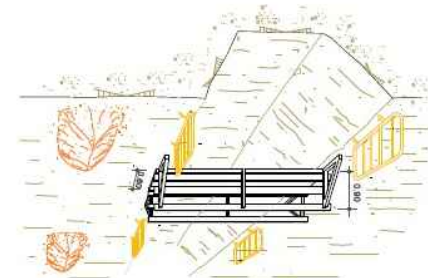
PROTECCIONES EN ZANJAS
