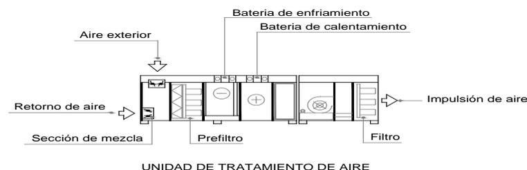
Además el aire será convenientemente filtrado en las mismas unidades, tanto el proveniente de la recirculación de aire de las salas como el de las renovaciones de aire exterior; de esta manera, garantizaremos la eliminación de posibles agentes contaminantes externos o de aquellos que puedan existir en las propias salas.
