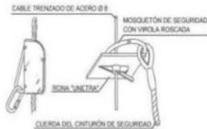
ANCLAJES CINTURÓN DE SEGURIDAD
