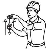
4 LEVANTAR EL AGUILON O PLUMA LENTAMENTE
