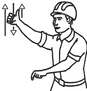
5 LEVANTAR EL AGUILON O PLUMA Y BAJAR LA CARGA
