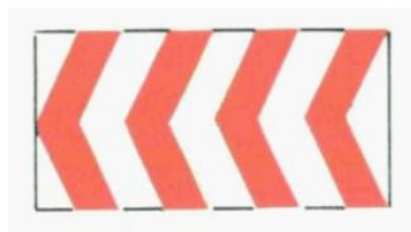
Figura 9. Elemento de balizamiento reflectante TB-1
