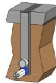
DETALLE EN PERSPECTIVA DE MICROZANJA S/E
