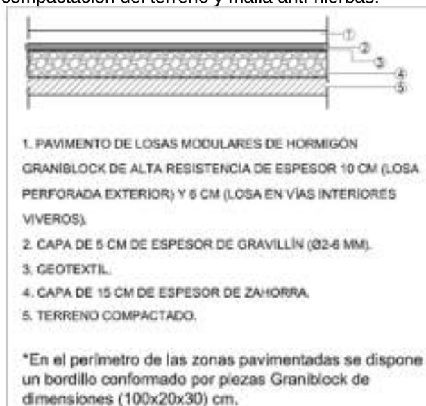
Ilustración 13 - Detalle de la disposición de los pavimentos
