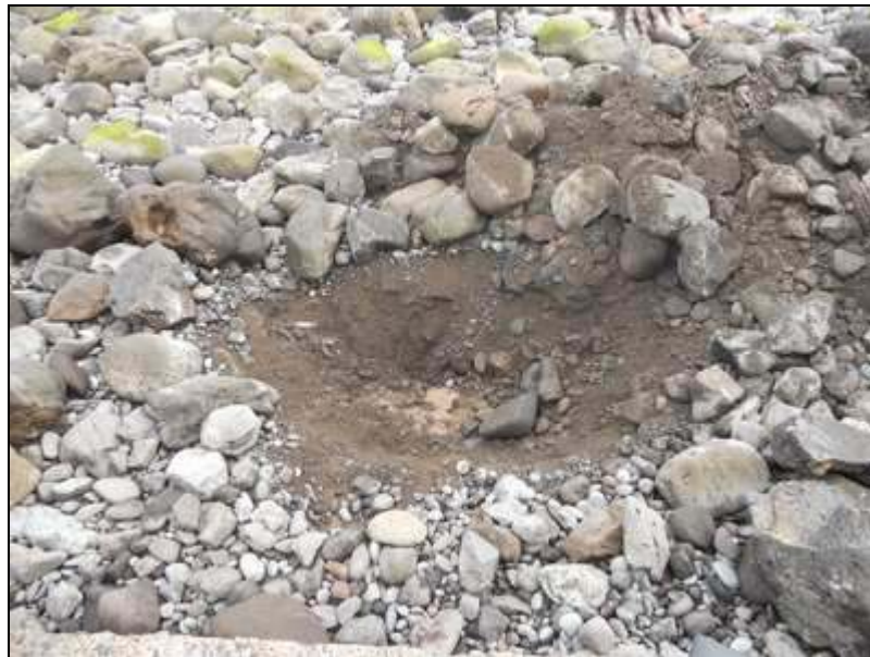
Figura 5. Imagen tomada durante la ejecución de la calicata 1
