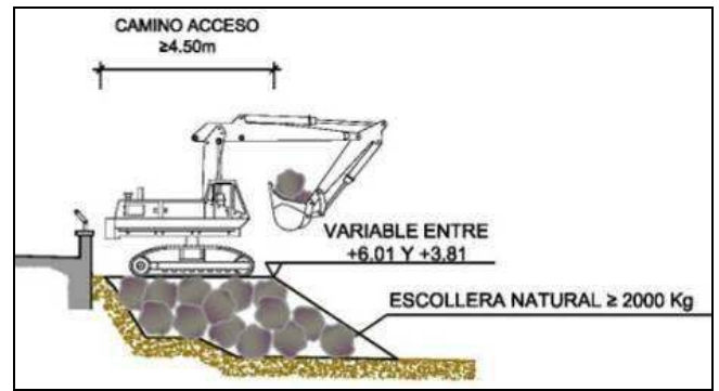
Figura 22. Formación de camino de acceso (Sección)
