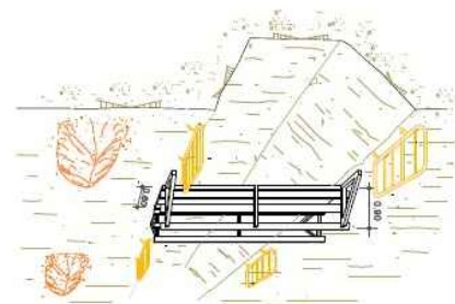
PROTECCIONES EN ZANJAS
