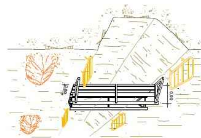
PROTECCIONES EN ZANJAS
