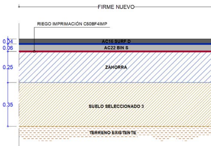
Figura 7. Sección de Firme
