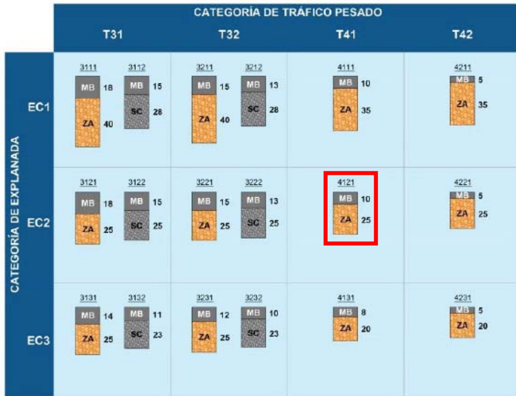
Figura 2. Catálogo de secciones sobre capa granular y sobre suelocemento para las categorías de tráfico pesado T31 a T42
