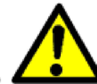
Peligro en general
