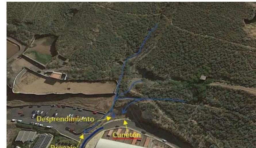
Figura 12. Situación de los diferentes cauces que confluyen bajo el muro que limita el parking de la facultad. Se indica la ubicación del desprendimiento debido a la rotura del cauce y el vertido hacia el talud, así como el punto por el que uno de los cauces drena hacia el interior del talud. Se marca el recorrido de la arroyada hacia el aulario Y la ubicación del drenaje que debe recoger todo el agua procedente de esta zona.
