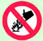
Prohibido apagar con agua
