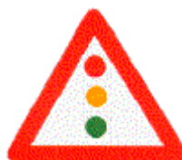
Figura. P-3: Peligro por la proximidad de una intersección aislada o tramo con la circulación regulada por semáforos.
