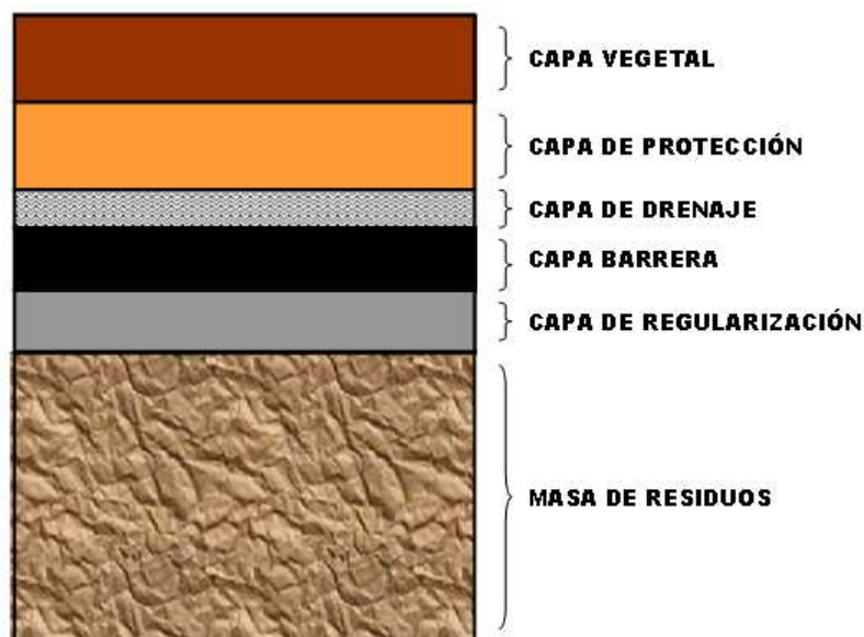
Figura 1.- Recubrimiento tipo de un vertedero.
