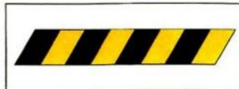
Figura 9.6. Señal de riesgo de caídas, desniveles, choques y golpes (riesgo permanente).
