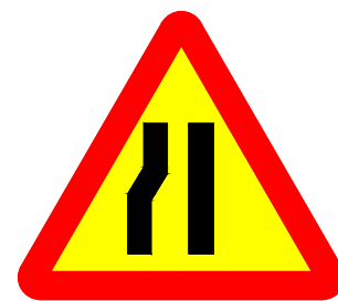
Estrechamiento de la calzada por la izquierda
