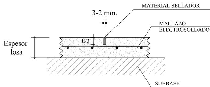
DIMENSIONES RECOMENDABLES Y MÁXIMAS DE LAS JUNTAS DE RETRACCIÓN EN LAS LOSAS DE UN PAVIMENTO
