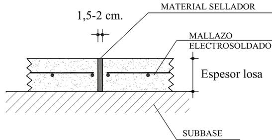
Cada 5 juntas de retracción, 1 junta de dilatación
