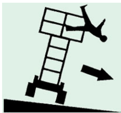
Figura 3 Plataforma de trabajo protegida parcialmente
