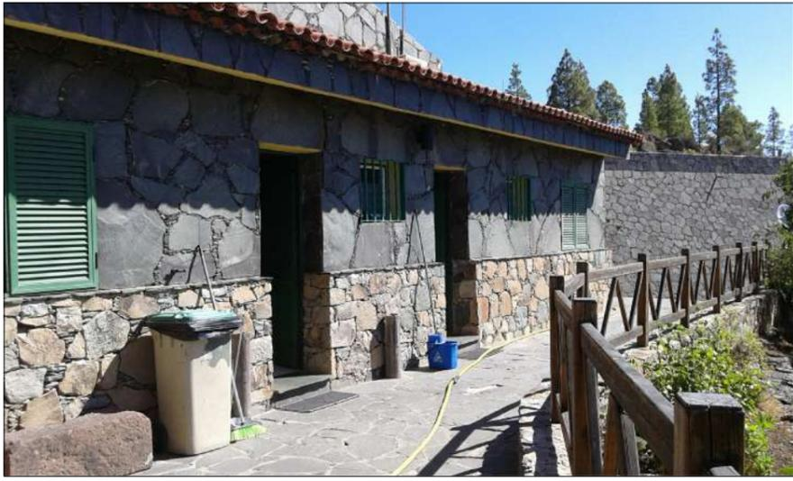
FOTO 1. Perspectiva desde la la terraza en la que se aprecia el tramo de barandilla a desmontar, el murete en el que se apoyarán 3 de los pilares de la marquesina y una de las luminarias de exterior que habrá que desmontar y recolocar.
