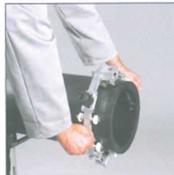
8. Colocar los extremos de los tubos en el interior del manguito y fijar todo el sistema en el **alineador** (apretar ligeramente).
