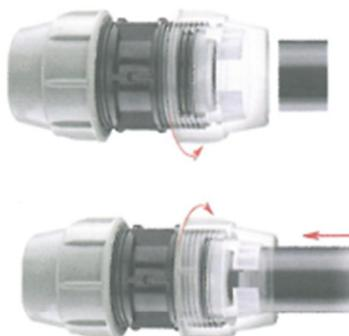
3. Insertar el extremo del tubo sin roscar la tuerca. Empujar el accesorio hasta que el tubo sobrepase la junta y llegue al tope.
