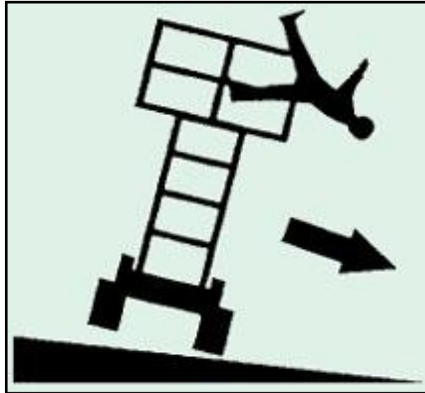
Fig. 2. Vuelco del equipo por falta de estabilidad.
