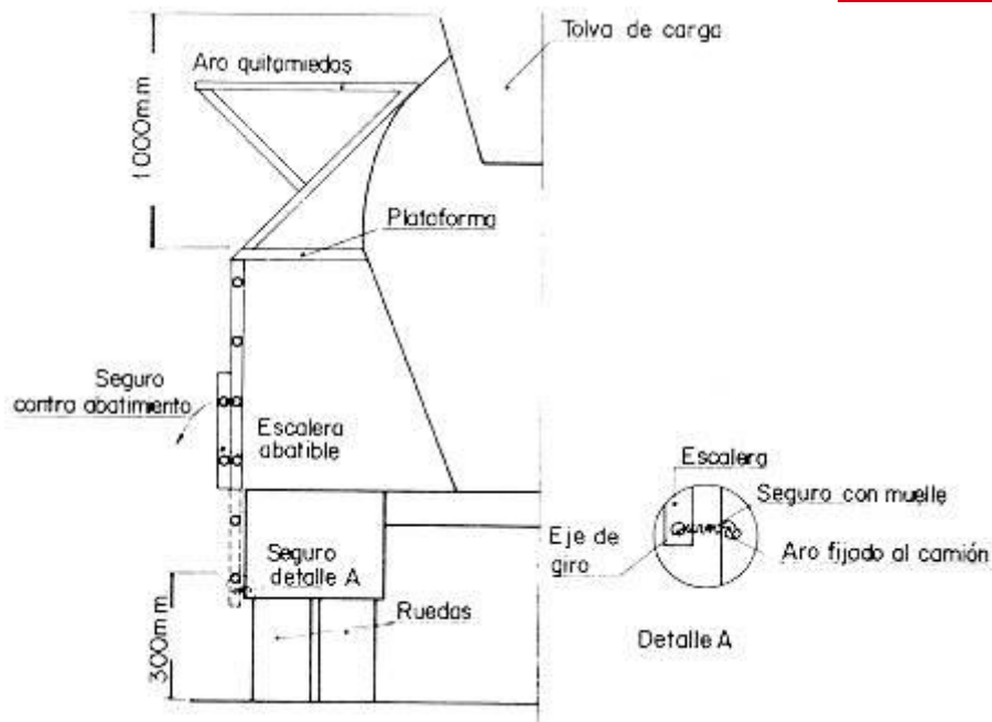
Escalera de acceso a la tolva
