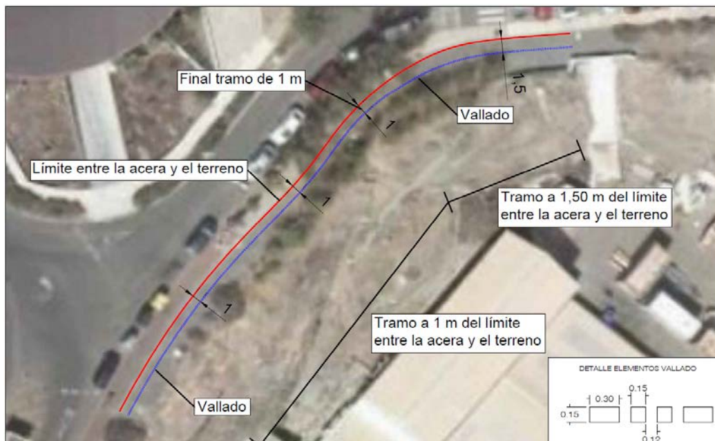
Imagen 2. Planta tramo 1 (mirador-caseta principal)
