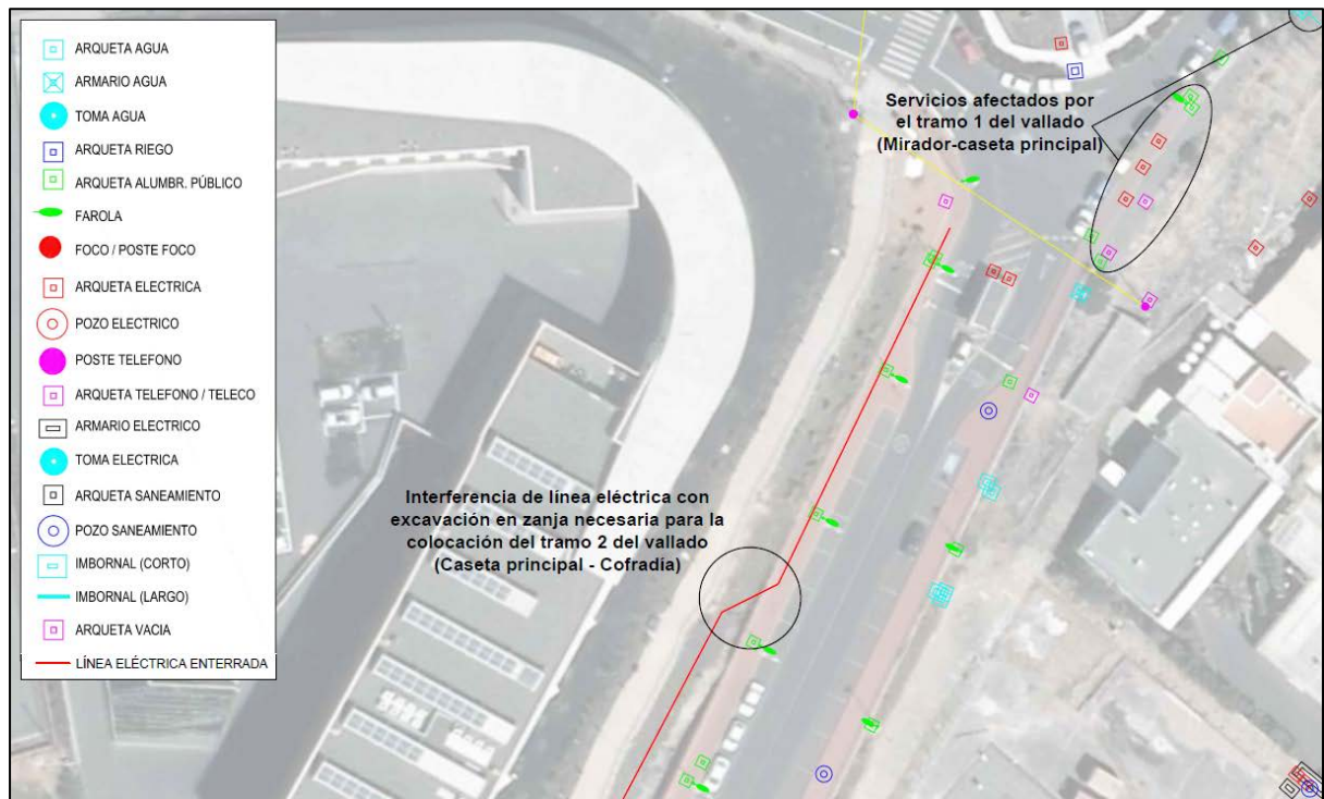
Imagen 1. Servicios afectados por el vallado en los tramos 1 y 2
