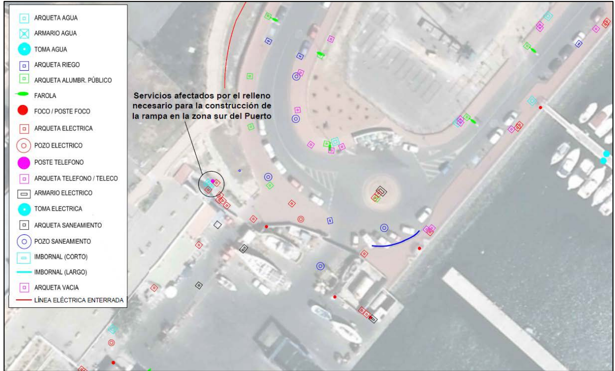
Imagen 2. Servicios afectados por la construcción de la rampa
