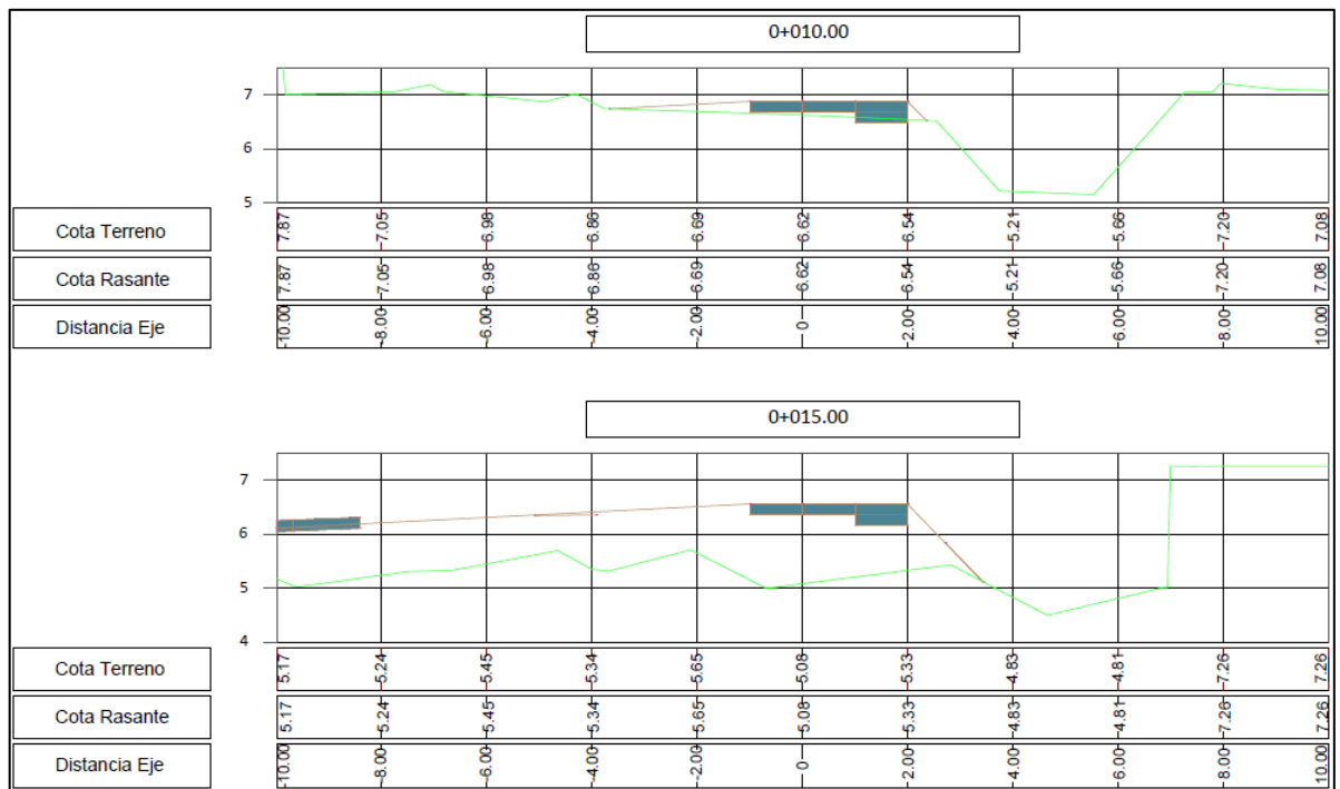
Perfiles transversales rampa (PK 0+010 – PK 0+015)
