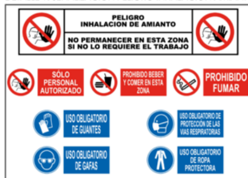
DETALLE 1: SEÑALIZACIÓN PELIGRO INHALACIÓN AMIANTO
