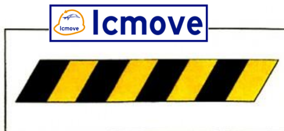
Figura 9.6. Señal de riesgo de caídas, desniveles, choques y golpes (riesgo permanente).
