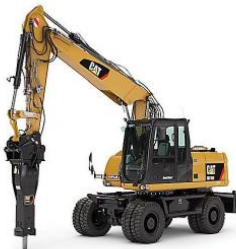
Ilustración 5. Ejemplo de retroexcavadora sobre neumáticos equipada con martillo neumático.
