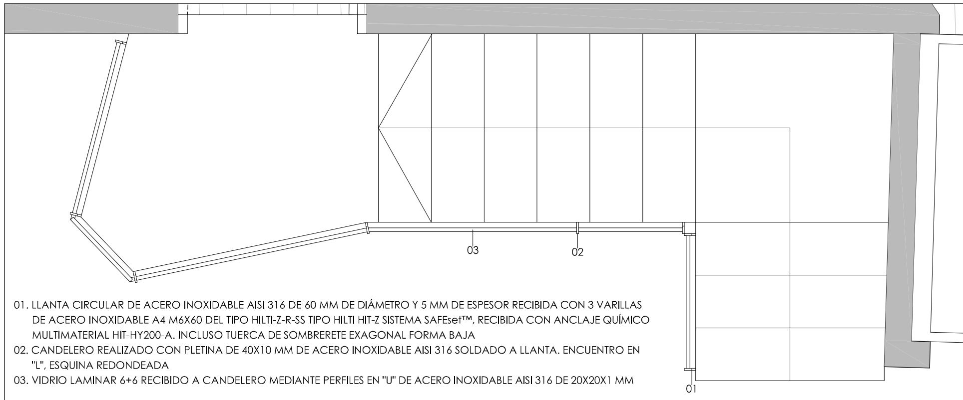
ESCALERA DE EMERGENCIA. DISPOSICIÓN DE CANDELEROS. PLANTA. ESCALA 1:20
