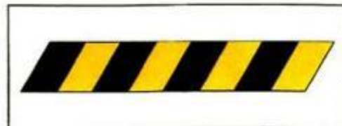
Figura 9.6. Señal de riesgo de caídas, desnieves, choques y golpes (riesgo permanente).
