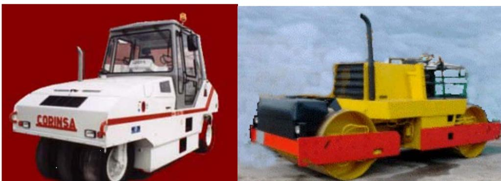
*Compactadoras autopropulsada de neumáticos y rodillos*
