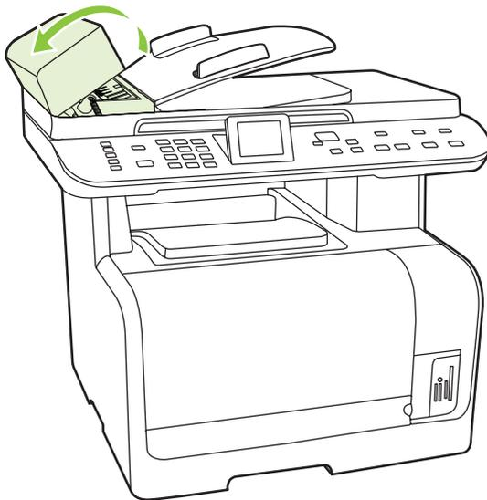
2. Levante la palanca verde y gire el mecanismo de captura hasta que se quede abierto.
