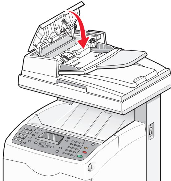
**5** Abra la cubierta del escáner y extraiga el papel atascado del área de alimentación del papel.
