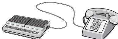
5 Conecte un tercer cable telefónico del contestador automático al puerto EXT de la impresora.
