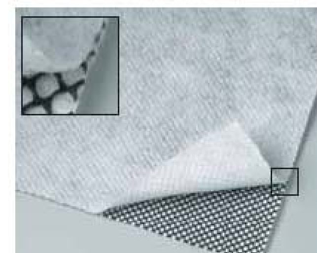
Figura 3.- Geocompuesto drenante formado por una georred de PEAD.
