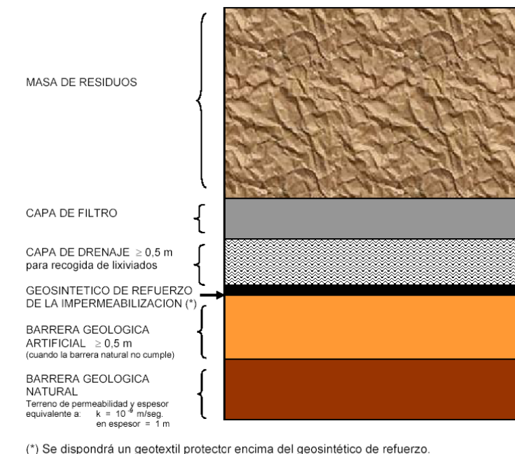
Figura 1. Condiciones mínimas exigidas a las barreras de protección de vertederos de residuos no peligrosos.
