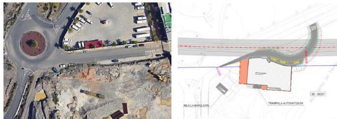
Salida de Emergencia N° 7 y Pozo de Ventilación N° 4
