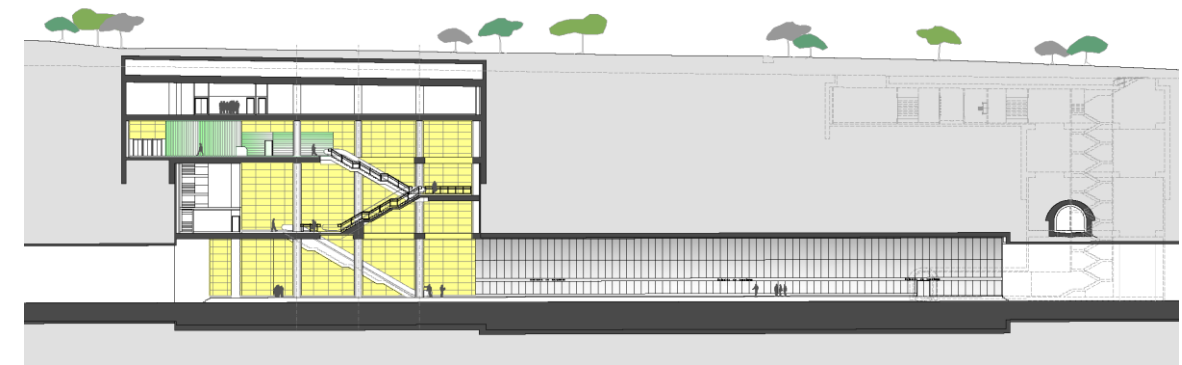
o Sección longitudinal estación de Hospitales (fuente: PC Estación Hospitales)
