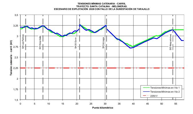
El valor mínimo de tensión catenaria – carril obtenido en la simulación es de 2.717,95 V, en el punto kilométrico 38+894, vía 2, valor superior al mínimo técnico exigido, 2.250 V.
