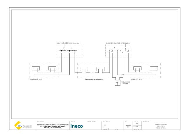
Doble red/cable de 66 kV y 20 kV. Se realizará línea simple de 66 kV que conectará las subestaciones de acometida (Sabinal y Matorral). A dicha línea de 66 kV se conectarán las subestaciones de tracción del tramo central de la traza de El Goro y Arinaga, el parque eólico y por supuesto las subestaciones de acometida de conexión a la red. En cada una
