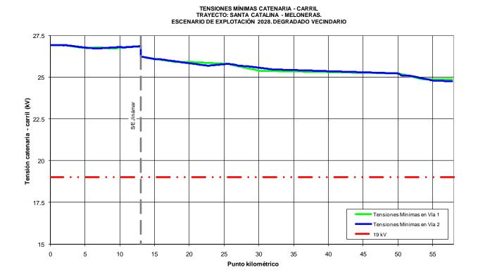
El valor mínimo de tensión catenaria – carril obtenido es de 24.763 V, en el punto kilométrico 56+690, vía 2, valor superior al mínimo técnico exigido, 20 kV.
