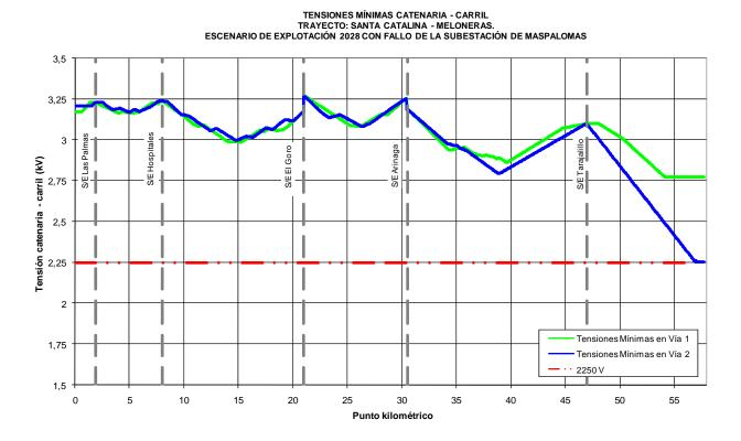
El valor mínimo de tensión catenaria – carril obtenido en la simulación es de 2.251,53 V, en el punto kilométrico 57+101, vía 2, valor superior al mínimo técnico exigido, 2.250 V.
