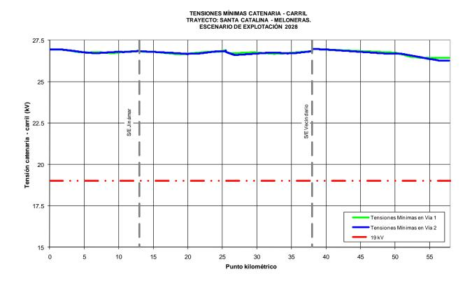
El valor mínimo de tensión catenaria – carril obtenido en la simulación es de 26.265 V, en el punto kilométrico 56+570, vía 2, valor superior al mínimo técnico exigido, 20 kV.
