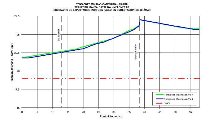
El valor mínimo de tensión catenaria – carril obtenido en la simulación es de 21770,82 V, en el origen del tramo, punto kilométrico 0+000, vía 1, valor superior al mínimo técnico exigido, 20000 V.
