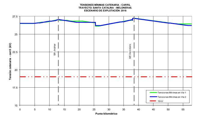
El valor mínimo de tensión catenaria – carril obtenido en la simulación es de 26126,15 V, en el punto kilométrico 26+453, vía 1, valor superior al mínimo técnico exigido, 20000 V.
