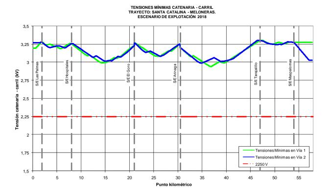
El valor mínimo de tensión catenaria – carril obtenido en la simulación es de 2.939,91 V, en el punto kilométrico 36+809, vía 1, valor superior al mínimo técnico exigido, 2.250 V.
