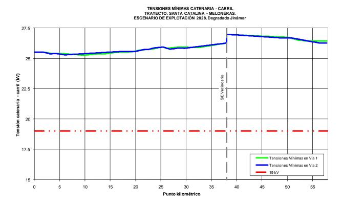
El valor mínimo de tensión catenaria – carril obtenido en la simulación es de 25.258 V, en el punto kilométrico 9+610, vía 1, valor superior al mínimo técnico exigido, 20 kV.
