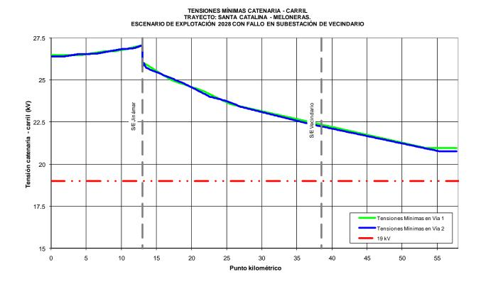
El valor mínimo de tensión catenaria – carril obtenido en la simulación es de 20763,61 V, en el punto kilométrico 57+768, vía 2, valor superior al mínimo técnico exigido, 20000 V.
