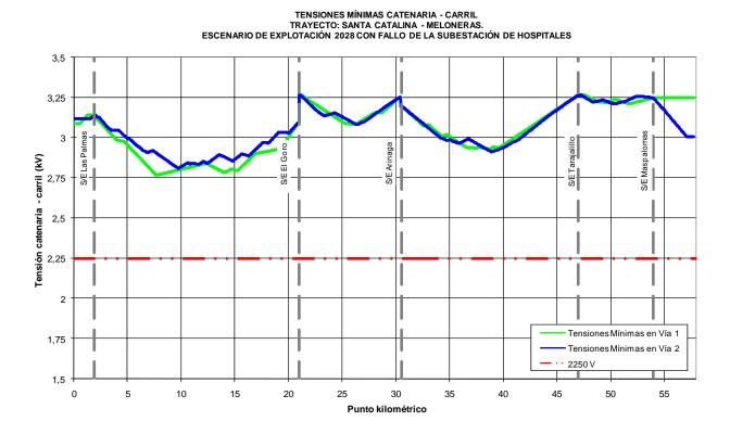
El valor mínimo de tensión catenaria – carril obtenido en la simulación es de 2.767,37 V, en el punto kilométrico 7+671, vía 1, valor superior al mínimo técnico exigido, 2.250 V.
