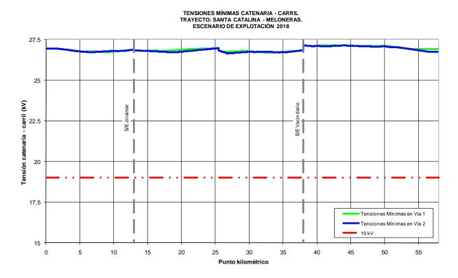
El valor mínimo de tensión catenaria – carril obtenido en la simulación es de 26.642,95 V, en el punto kilométrico 26+755, vía 2, valor superior al mínimo técnico exigido, 20 kV.
