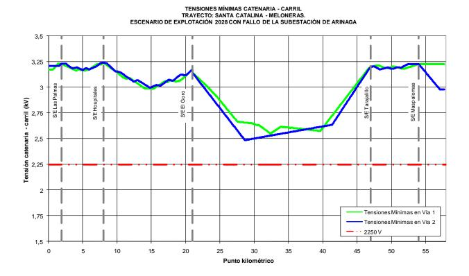
El valor mínimo de tensión catenaria – carril obtenido en la simulación es de 2.486,18 V, en el punto kilométrico 28+674, vía 2, valor superior al mínimo técnico exigido, 2.250 V.
