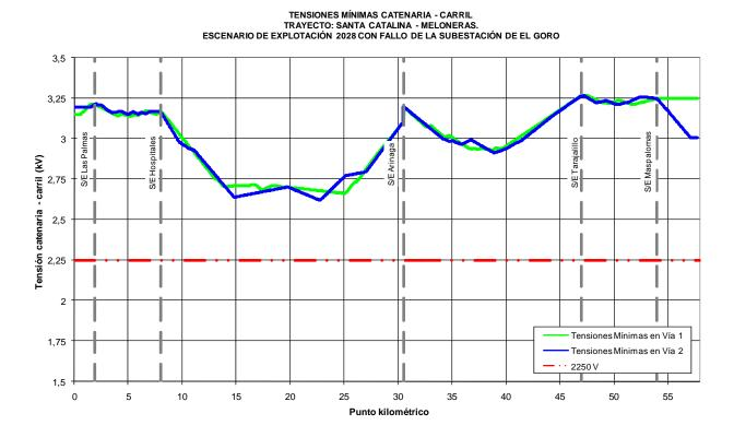
El valor mínimo de tensión catenaria – carril obtenido en la simulación es de 2.619,72 V, en el punto kilométrico 22+782, vía 2, valor superior al mínimo técnico exigido, 2.250 V.
