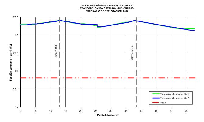
El valor mínimo de tensión catenaria – carril obtenido en la simulación es de 25663,81 V, en el punto kilométrico 57+768, vía 2, valor superior al mínimo técnico exigido, 20000 V.
