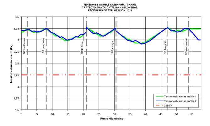
El valor mínimo de tensión catenaria – carril obtenido en la simulación es de 2.912,85 V, en el punto kilométrico 38+894, vía 2, valor superior al mínimo técnico exigido, 2.250 V.
