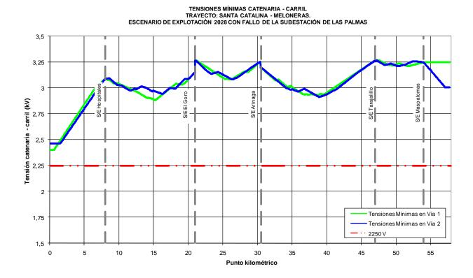
El valor mínimo de tensión catenaria – carril obtenido en la simulación es de 2.402,23 V, en el punto kilométrico 0+579, vía 1, valor superior al mínimo técnico exigido, 2.250 V.
