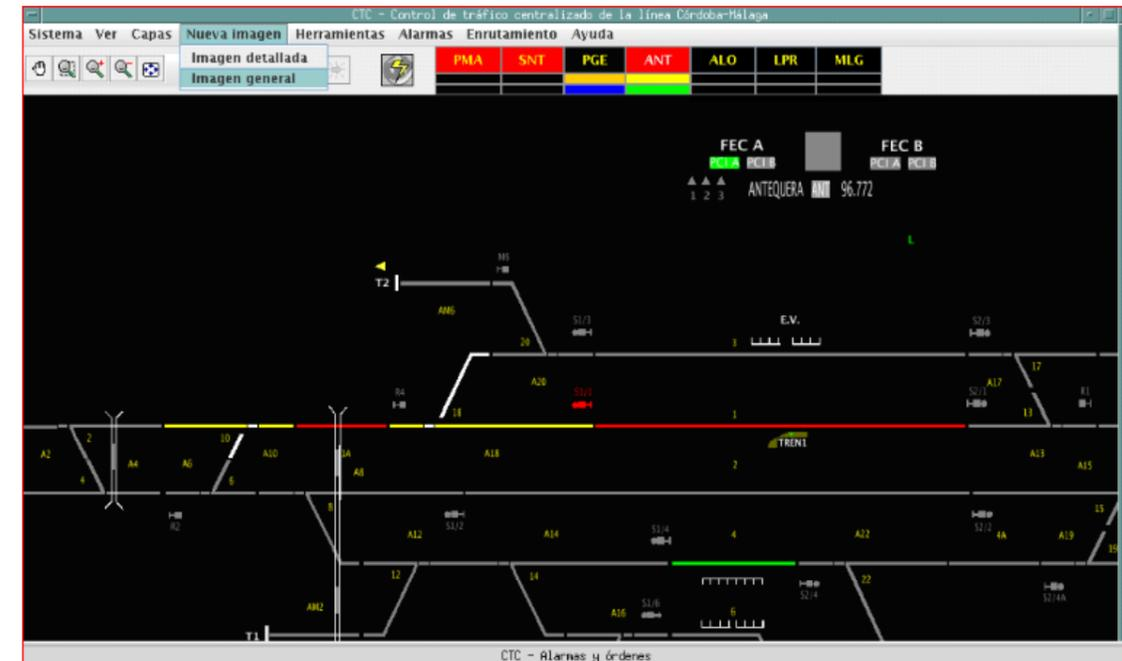
Figura 7 Ejemplo de sinóptico del CTC integrado
