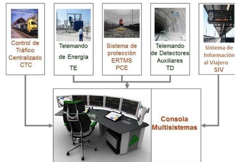
Imagen de terminal multisistemas (fuente: elaboración propia)
