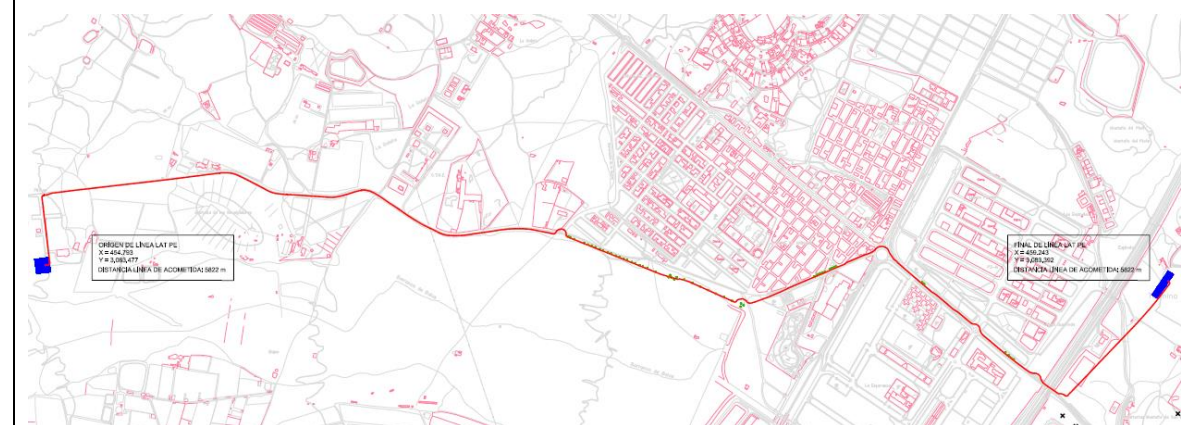
Imagen línea de acometida de 66 kV entre la subestación evacuadora del parque eólico y la subestación de acometida de FGC en Arinaga PC
