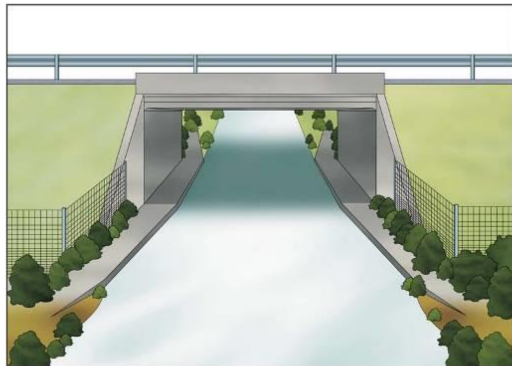
Ilustración 6.2. Esquema general de un drenaje adaptado para animales terrestres
