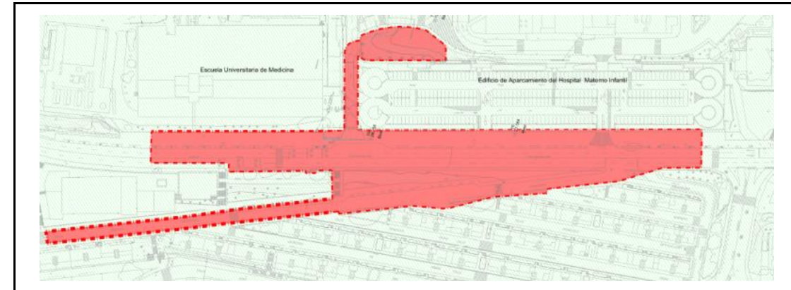
Zona de instalación auxiliar temporal y zona de obras de la estación de Hospitales
